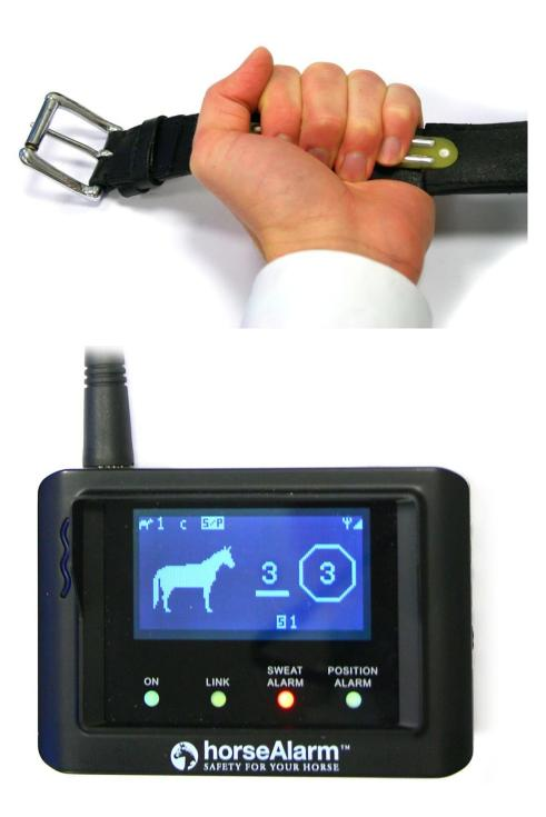
Cuando el nivel de transpiración medido es tan alto como el nivel de su alarma (o superior), el receptor empieza a activar la alarma con luz roja y con sonido. Para apagar la alarma, suelte los sensores y pulse el botón (C).
