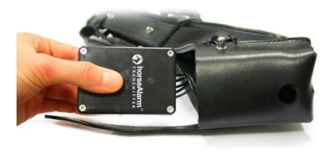
Desatornille los 4 tornillos para abrir el transmisor. Quite la pequeña pieza de papel entre las baterías o inserte nuevas. Esto hará que se encienda el transmisor y le permitirá enviar valores al receptor. Mantenga el transmisor fuera del bolso colocado de forma plana "en la parte posterior", con el logo orientado hacia arriba.
