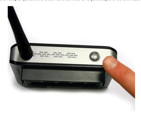
**4.** Asegúrese de que está usando el ajuste "Modo Simple" en el receptor pulsando el botón "D" hasta que aparezca la imagen que muestra un caballo.
